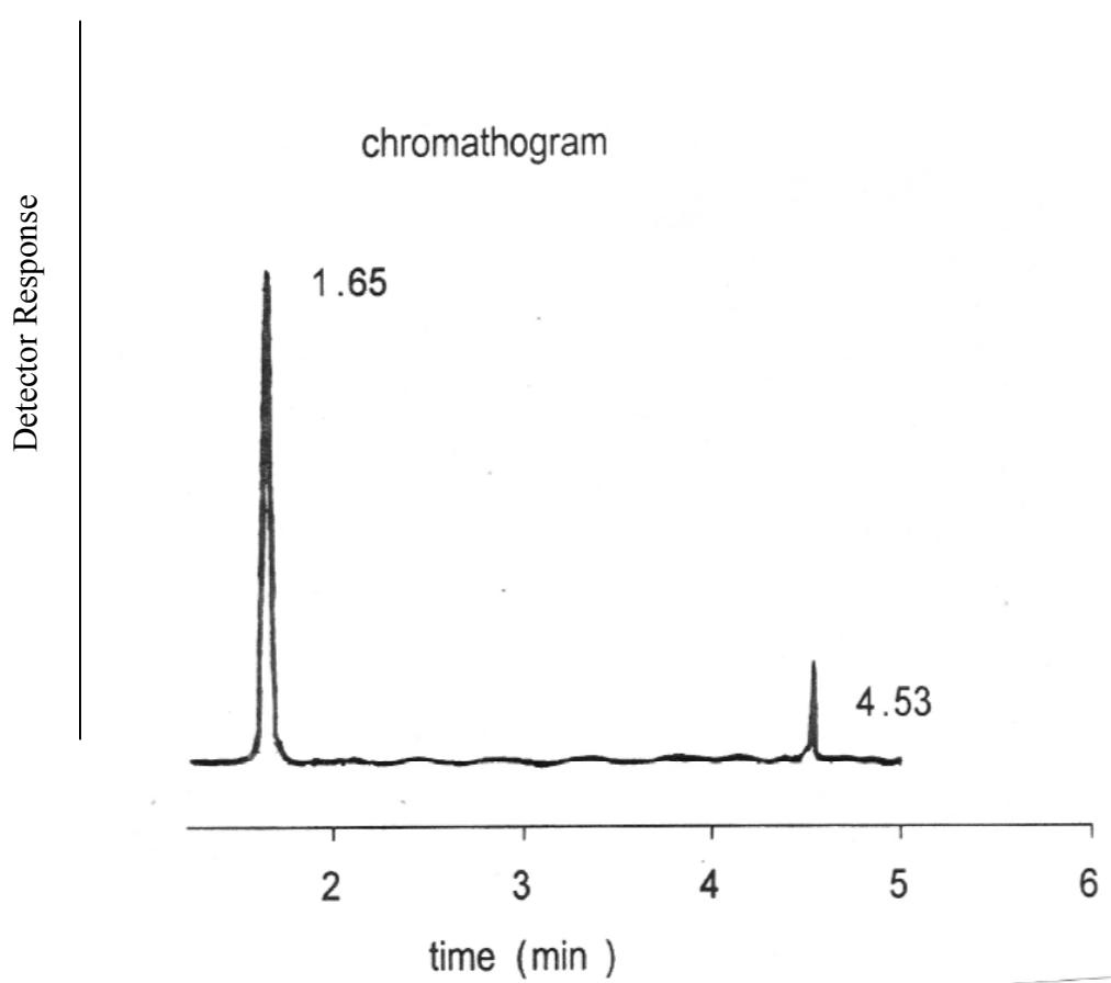
شکل ۱ - کروماتوگرام مربوط به مونومراستایرن که در نتیجه ارزیابی از تزدیق نمونه مجهول آزمایشگاهی به دست آمده است. مشخصات ستون مورد نظر به صورت (۲۵cm \* ۴.۶ mm, id : ۵  $\mu\text{m}$ ) می باشد. پیک اول مربوط به استونیتریل (فاز متحرک) است که زمان باز داری آن ۰.۶۵ دقیقه است و پیک دوم مربوط به مونومراستایرن با زمان باز داری ۰.۵۳ دقیقه می باشد. طول موج تشخیص (u.v) در ۲۴۵ نانومتر، AUFS دستگاه برابر ۰.۰۰۵ و سرعت جریان فاز متحرک برابر یک میلی لیتر در دقیقه می باشد.
