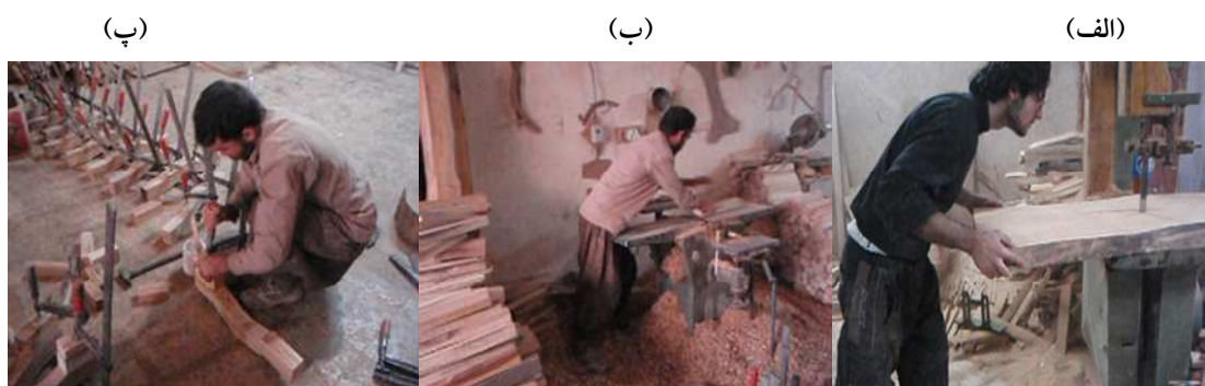
شکل ۱- وضعیت های بدنی نامطلوب کارگران کارگاه تهیه مبیل خام در انجام وظایف الف) برش چوب با دستگاه اره فلکه، ب) رنده با دستگاه سه کاره و پ) بستن قطعات با پیچ گوشتی.
