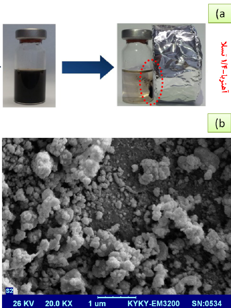
شکل ۲- (a) جداسازی ذرات مغناطیسی فاز جامد از محلول بدون نیاز به سانتریفیوژ یا فیلتراسیون (Woo et al. 2014)؛ (b) تصویر اسکن شده توسط میکروسکوپ الکترونی از سطح پلیمر ساخته شده در یک صنعت خودرو سازی
